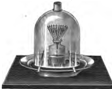
Darstellung von Unterphosphorsäure.
